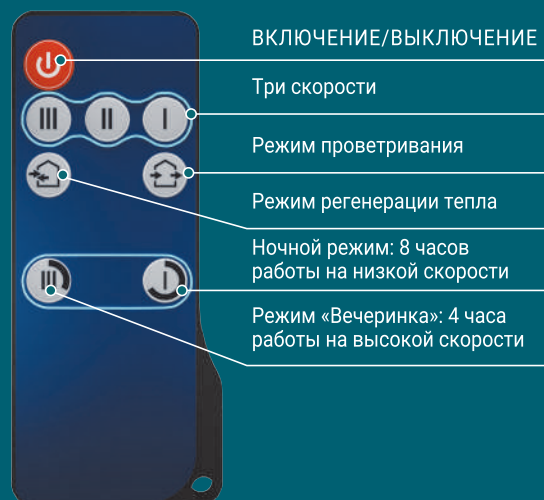
Схема пульта ДУ модели Expert
